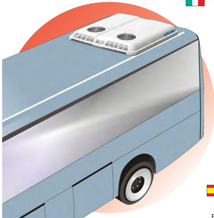
Condizionatore a tetto di configurazione innovativa con capacità di condizionare autobus fino a 40 posti. Versatile e compatto, utilizza i condotti laterali o i canali a cappelliera per la distribuzione dell'aria.
