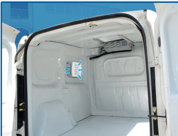
Esempio di installazione a parete su un veicolo trasporto farmaci Example of wall-mounting on drugs transport vehicle
