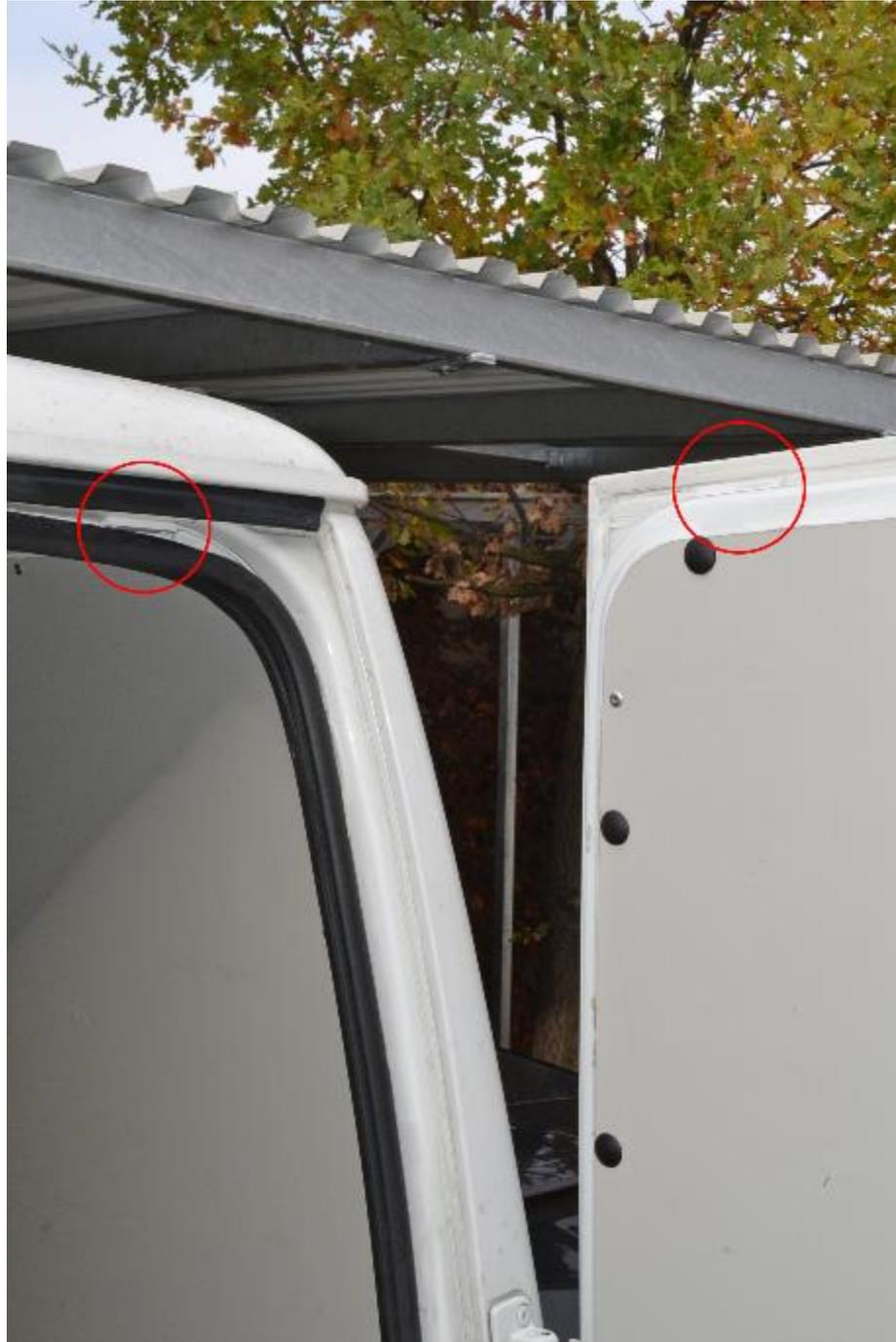
**Registratore della temperatura da posizionare in cabina di guida dotato di sensori porte.**
